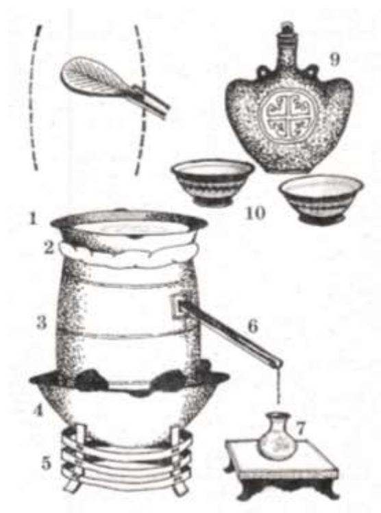
Рисунок 18 – Утварь для перегонки молочной водки «Арага»
